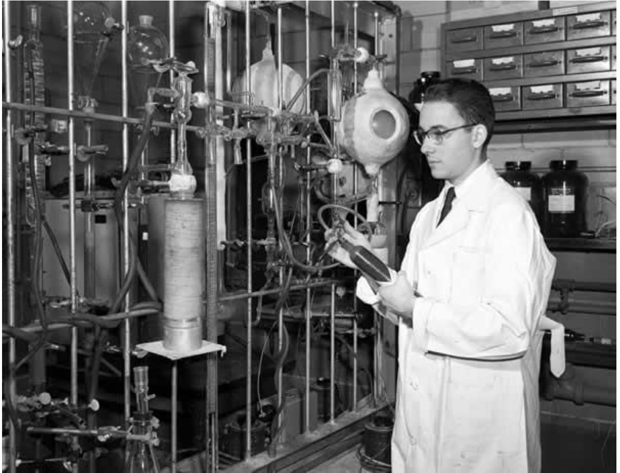
Harold Urey y Stanley Miller demostraron en 1953 que se pueden formar moléculas orgánicas a partir de sustancias inorgánicas simples, si se dan las condiciones adecuadas. En la imagen, Miller junto al aparato que diseñaron para simular la atmósfera primitiva de la Tierra. (© Corbis / Cordon Press.)
